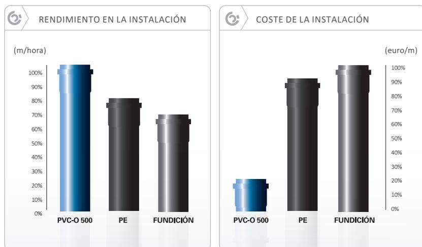
Gráficos para una tubería DN200 DN250 mm PN16 bares
