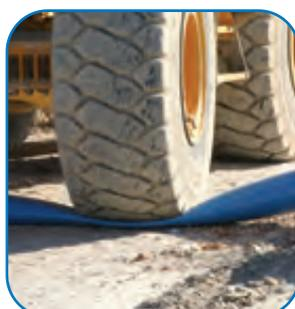
El excelente comportamiento elástico de las tuberías en **PVC-O Clase 500** les permite soportar grandes deformaciones del diámetro interior. La tubería recupera inmediatamente su forma original tras un aplastamiento o accidente mecánico inesperado, lo cual elimina el riesgo de roturas por deslizamiento del terreno, piedras o maquinaria.
