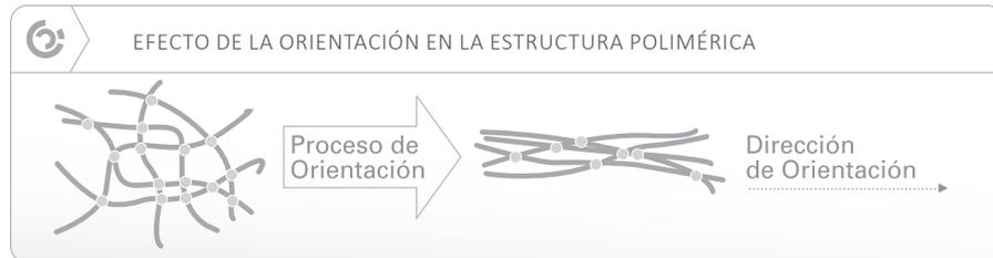
El proceso de Orientación Molecular modifica la estructura del PVC ordenando en línea las moléculas del polímero.
