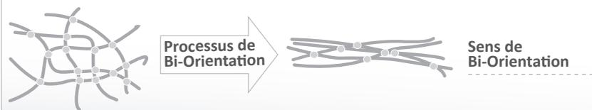
Le processus de bi-orientation moléculaire modifie la structure du PVC en alignant les molécules du polymère.
