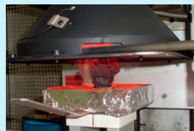
As provetas de PVC devem aumentar a sua espessura inicial em 800% no mínimo para obter a marca NF Me
