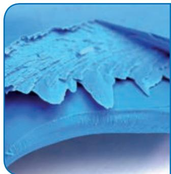
Quando o PVC da estrutura amorfa (secção inferior) se submete ao processo de orientação, obtém-se uma estrutura laminar (secção superior).
