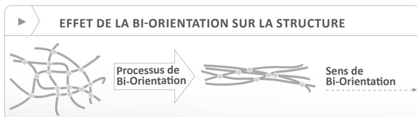
Le processus de bi-orientation moléculaire modifie la structure du PVC en alignant les molécules du polymère.
