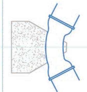
Il est important de verser directement le béton dans l'emplacement prévu à cet effet en ayant au préalable contrôlé la résistance mécanique du terrain. Lors de la conception des ancres, il faut **prévoir le dégagement des jonctions**, afin de permettre leur contrôle pendant les épreuves hydrauliques.
