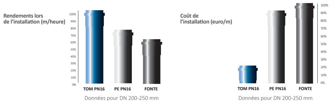
La grande résistance de la canalisation TOM® permet de **meilleurs rendements en termes de déchargement, de pose en tranchée et d'emboîtement entre tubes**. De plus, la facilité d'emboîtement des différentes canalisations entre elles, procure des rendements très élevés : puisqu'un personnel peu qualifié peut le manipuler sans l'aide de machine jusqu'au DN315.
