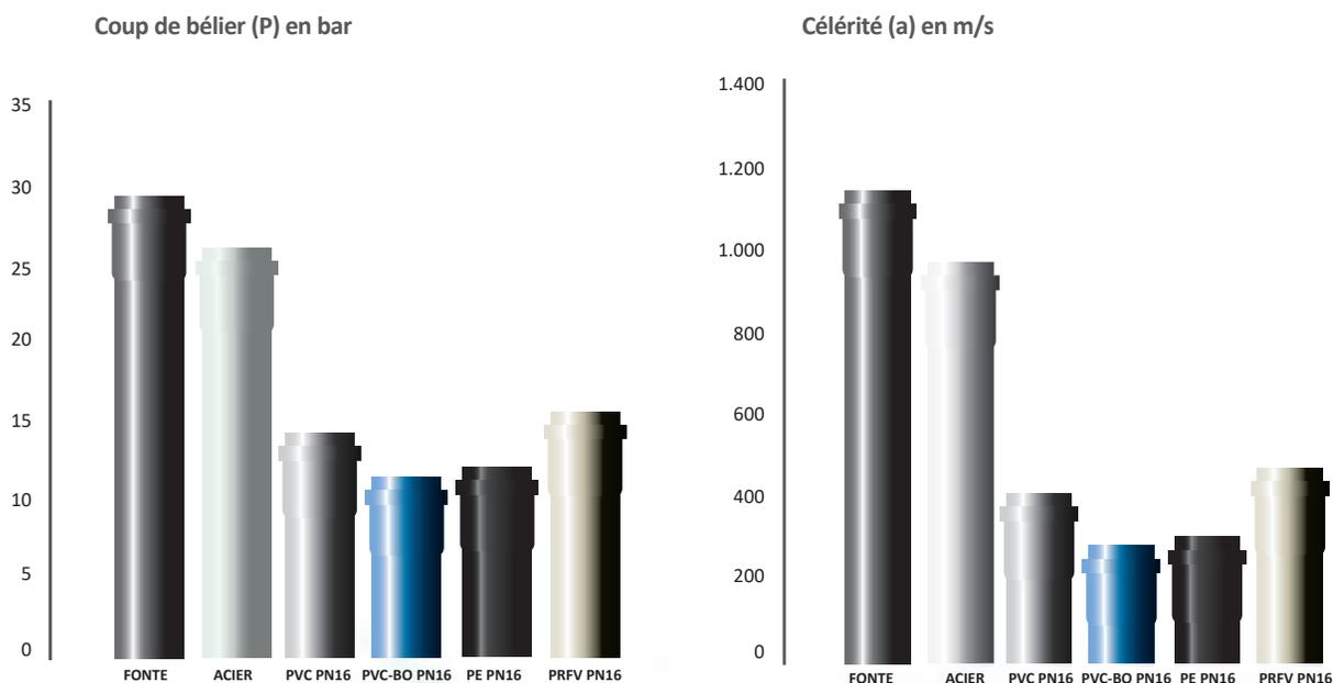
Surpression produite par la fermeture brusque d’une conduite d’eau à 2,5 m/s.
