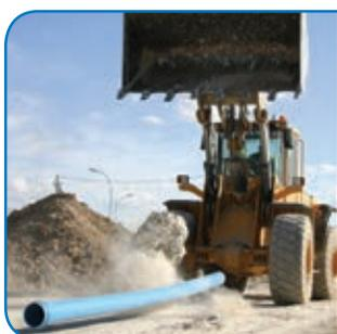
Après la chute d'un rocher de 500 kg d'une hauteur de 3 m sur le tube TOM®, celui-ci demeure intact.
