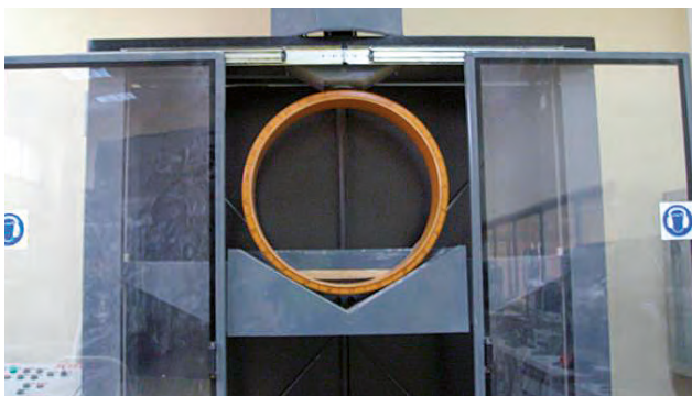
ENSAYO DE RIGIDEZ DE UN TUBO FLEXIBLE.
